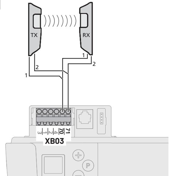
Eine angeschlossene Lichtschranke wird von der Steuerung automatisch erkannt, sobald die Stromversorgung angeschlossen ist. Die Lichtschranke kann nachträglich umprogrammiert werden. Nicht gewünschte Lichtschranken müssen abgeklemmt werden bevor die Stromversorgung angeschlossen wird, da die Steuerung sie sonst erkennt.
